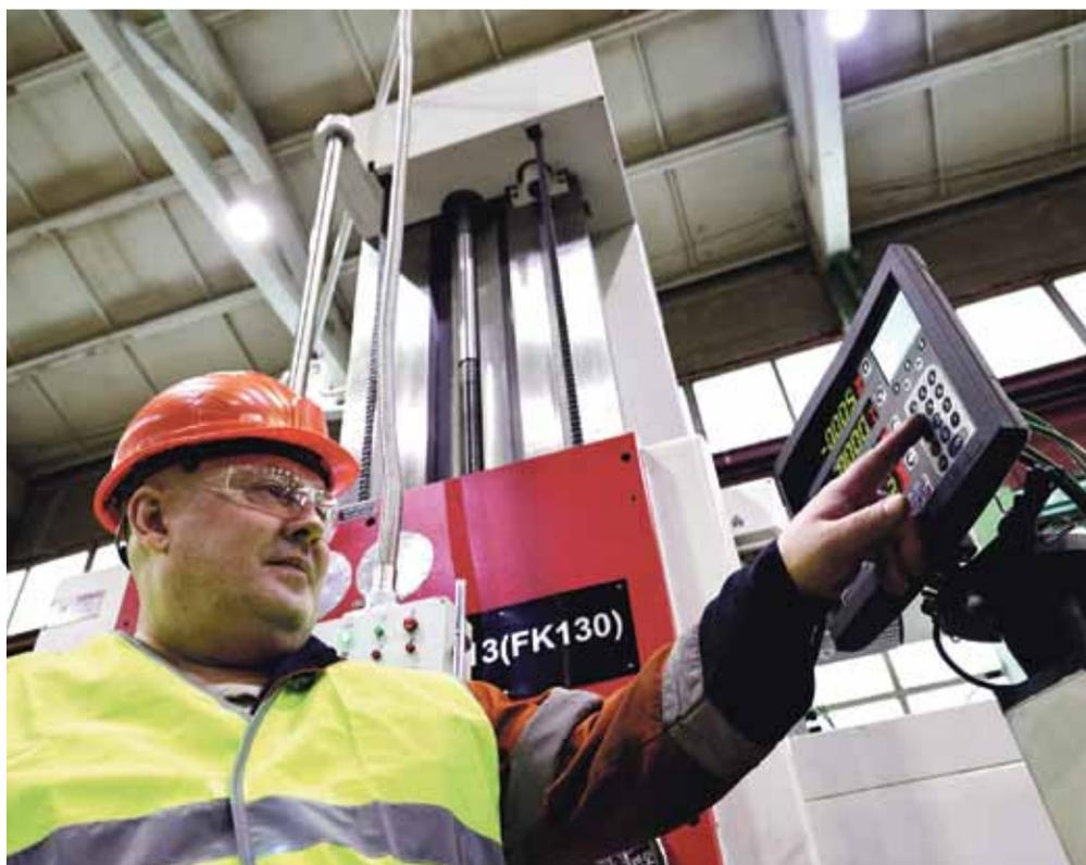
С ТОЧНОСТЬЮ ДО МИКРОНА РАБОТАЕТ НОВЫЙ ГОРИЗОНТАЛЬНО-РАСТОЧНОЙ СТАНОК НА ВОРКУТИНСКОМ МЕХАНИЧЕСКОМ ЗАВОДЕ (ВМЗ). ПОМИМО ЭТОГО, ОН ЗНАЧИТЕЛЬНО ЭКОНОМИТ ВРЕМЯ ТОКАРЯМ, АВТОМАТИЧЕСКИ КОНТРОЛИРУЯ ПАРАМЕТРЫ.
